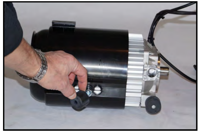
Oter les amortisseurs en caoutchouc.
