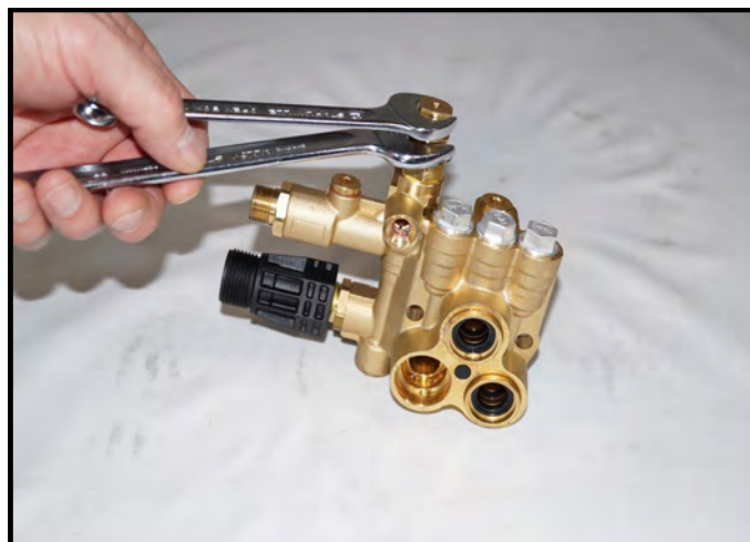
Réglage de la pression retenue MC 3C
