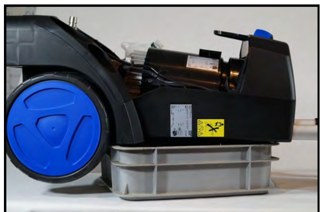
Coucher la machine en arrière sur un bac pour récupérer l'huile usagée.
