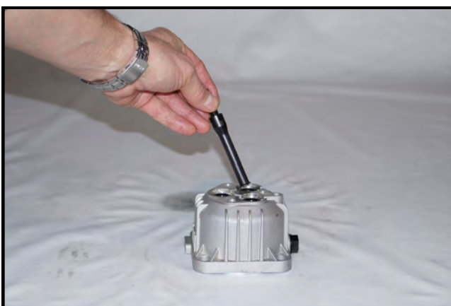
Extraire les 3 joints d'huile avec un extracteur ( type BAHCO 4521N sur la photo)
