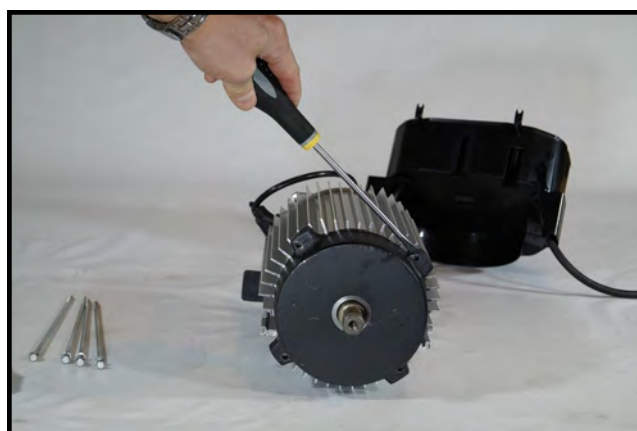
Décoller le flasque arrière moteur à l'aide d'un gros tournevis plat ou similaire. Déposer le flasque arrière.
