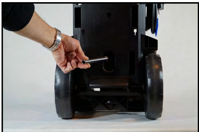
Incliner la machine vers l'avant pour ôter le bouchon et viser à la place du bouchon un tube de 180mm avec un filetage en 3/8".
