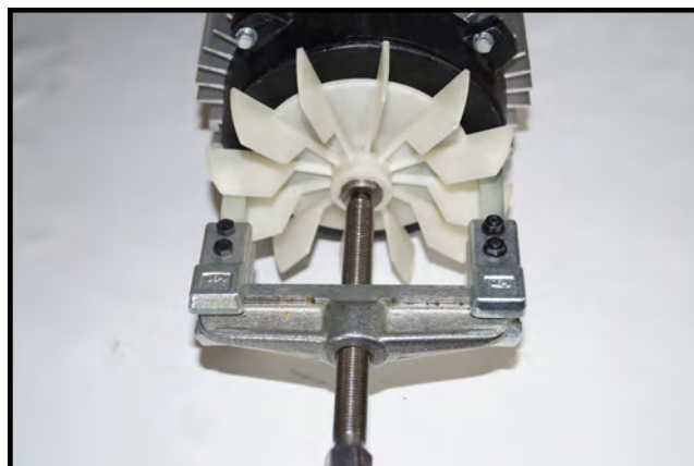
Pull off moteur fan.
