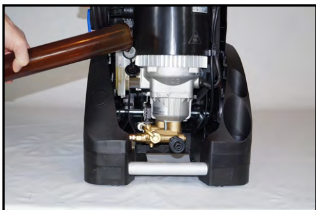
Remplissage de l'huile de pompe. (SAE 80W/90 API GL-5)
