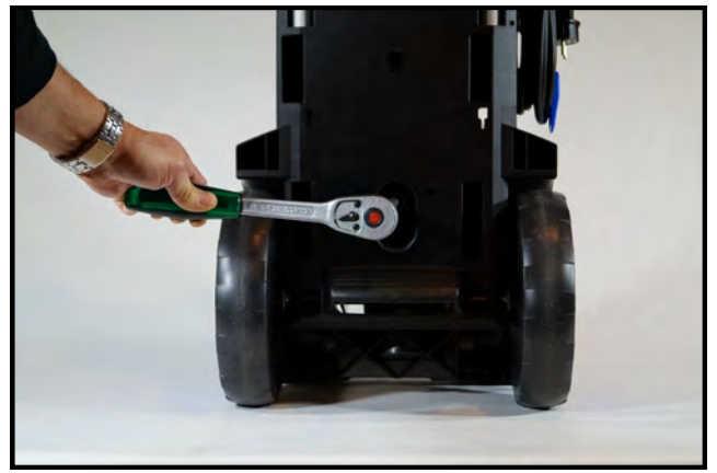
Déposer le bouchon avec une douille de 17mm
